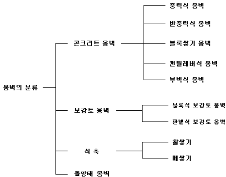
[그림 13.1] 재료형식에 따른 옹벽 분류
